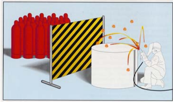
Abb. 4.2: Beispiel für Abschirmmaßnahmen bei Arbeiten mit Funkenflug 4 .
