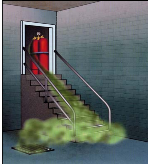
Abb. 2.3: Ausbreitungsverhalten von verflüssigten Gasen (Beispiel) 4 .
