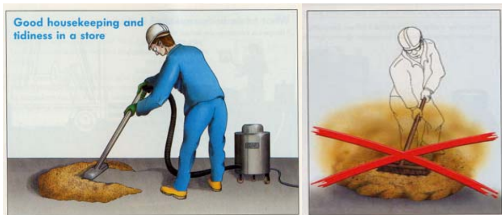
Abb. 3.2: Beseitigung von Staubablagerungen 4 .
