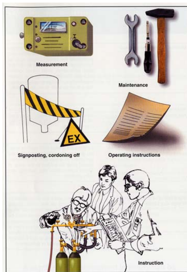
Abb. 4.1: Beispiele für organisatorische Maßnahmen des Explosionsschutzes 4 .
